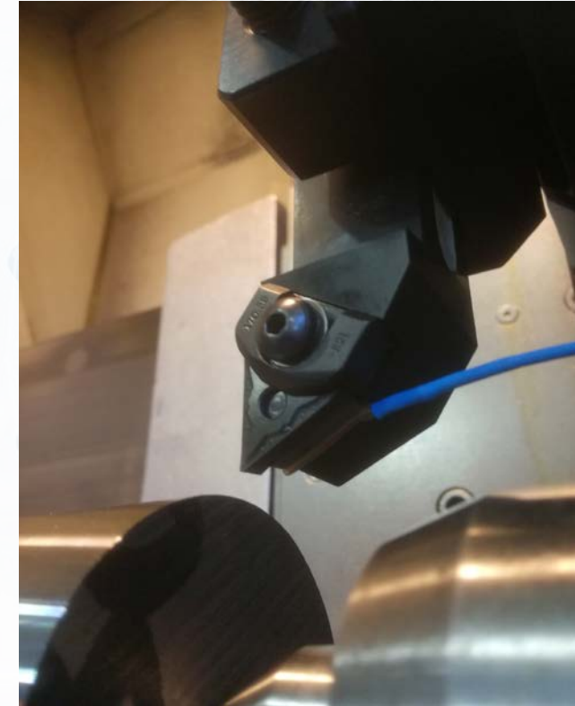
Montaggio diretto sotto lo shim
