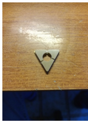
Piezoceramico sezionato in situ
